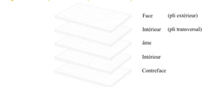
Figure 2 : composition d'un panneau de 5 plis
