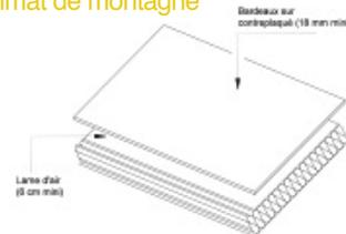
Figure 45 : Fixation sur pannes ou fourrures en bois
