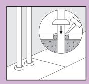
Afin de garantir une protection supplémentaire contre l'eau autour du périmètre du sol et d'éviter toute pénétration d'eau sous les panneaux, appliquez le PG Aqua Sealant flexible jusqu'à la base des murs, aux seuils, aux chambranles, aux rosaces, etc.
