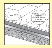
La teneur en humidité du support doit être inférieure à 2,5 % d'humidité du béton / 75 % d'humidité relative (chape de ciment) ou inférieure à 0,5 % d'humidité du béton / 50 % d'humidité relative (chape d'anhydrite ; sousplancher). Dans le cas d'un chauffage par le sol, les résultats doivent être respectivement de 1,5 % d'humidité du béton / 60 % d'humidité relative et de 0,3 % d'humidité du béton / 40 % d'humidité relative.
