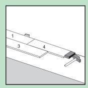
Dans les endroits où il est trop difficile de poser les lames avec les cales de frappe (par exemple, contre le mur), vous pouvez les taper ensemble en utilisant l'anneau de tirage et un marteau.
