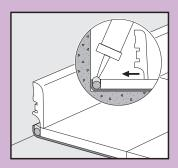
Pour une finition résistante à l'eau du profilé de moulure 5- in -1 (PGINCP), le profilé de moulure 5- in -1 au sol de base avec la colle PG Multiglue et/ou des vis. Appliquez le mastic PG Aqua Sealant transparent sur la mousse de PE souple qui se trouve dans le joint de dilatation. Poussez le profilé de moulure 5-in-1 dans le profilé de base et le mastic PG Aqua Sealant humide.
