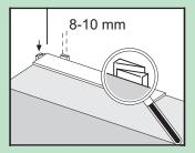
Bien entendu, vous devez également scier les panneaux. Afin d'obtenir une découpe nette, le côté à motifs doit être vers le bas lorsque vous utilisez une scie sauteuse ou une scie à main circulaire et vers le haut lorsque vous utilisez une scie à main ou une scie de long. Veillez à ce que les joints d'extrémité des panneaux en deux rangées successives ne soient jamais alignés. Assurez-vous toujours que les joints sont bien décalés d'au moins 30 cm / 12 pouces.
