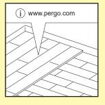
Posez les lames de parquet de façon perpendiculaire par rapport au sousplancher existant. Le vide sanitaire se trouvant sous le plancher doit être suffisamment ventilé.
