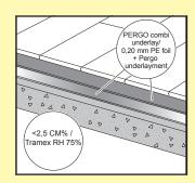
Assurez-vous que le sous-plancher est nivelé. Toute irrégularité supérieure à 4 mm sur une longueur de 2 m doit être lissée. Il en est de même pour toute irrégularité de plus de 1 mm sur une longueur de 20 cm. Cette règle ne tient pas compte des réglementations nationales en matière de nivellement.
