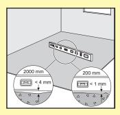
Après avoir vérifié les irrégularités du sous-plancher, passez soigneusement l'aspirateur sur toute la surface. Assurez-vous que la base du sol est plane, propre, ferme et sèche. Afin d'éviter les risques de grincement, fixez, à l'aide de vis, tout panneau de particules, panneau OSB, panneau de fibres, lame en bois, etc.
