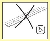
Vérifiez si les anciennes plinthes peuvent être retirées. Vous pouvez laisser les plinthes du mur à leur place et terminer le sol à l'aide des profilés Pergo ou couvrir les plinthes existantes à l'aide de la plinthe à recouvrement Pergo.
