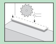
Placez la lame dont les côtés sont sciés contre les murs. Placez des cales de dilatation, du kit de pose, entre les lames et le mur. Cette étape garantira que votre joint de dilatation est suffisamment large : de 8 à 10 mm (de 5/16 po à 3/8 po).
