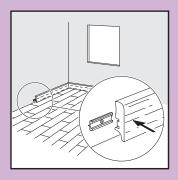
Lorsque vous sciez les panneaux, assurez-vous que le joint de dilatation sous la porte se situe à minimum 10 mm. Si vous ne pouvez pas soulever le panneau, servez-vous de la cale de frappe ou de l'anneau de tirage et du marteau afin de taper les panneaux ensemble, lorsque les lames sont à plat sur le sol.
