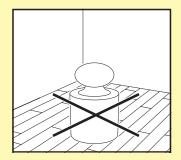
Le sol stratifié Pergo est conçu pour être posé en tant que sol flottant, et ce, afin de permettre la dilatation et la contraction naturelles selon les changements de température et d'humidité. Afin de tirer profit d'un sol flottant et d'éviter les éventuels écarts, le grincement, etc., ne fixez jamais le sol à l'aide de clous, de vis, de silicone, etc.
