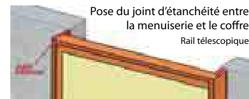
Pose d'étanchéité sur la menuiserie
