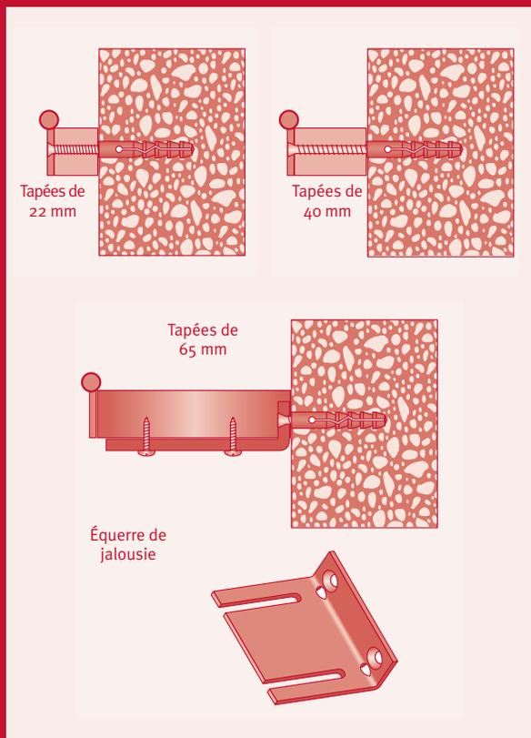
Vues de coupe de l'assemblage de la tapée incorporée sur la maçonnerie
