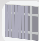
Pose verticale double lambourrage
