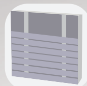
Pose horizontale simple lambourrage
