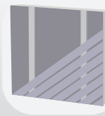
Pose diagonale simple lambourde
