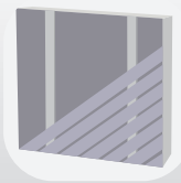
Pose diagonale simple lambourde
