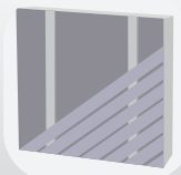
Pose diagonale simple lambourde
