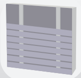
Pose horizontale simple lambourde
