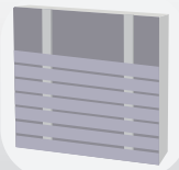
Pose horizontale simple lambourde
