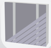
Pose diagonale simple lambourde
