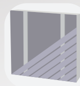
Pose diagonale simple lambourde
