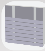
Pose horizontale simple lambourrage
