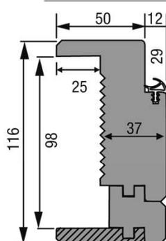
Arrêt du carrelage au sol dans l'alignement de la cloison côté porte
